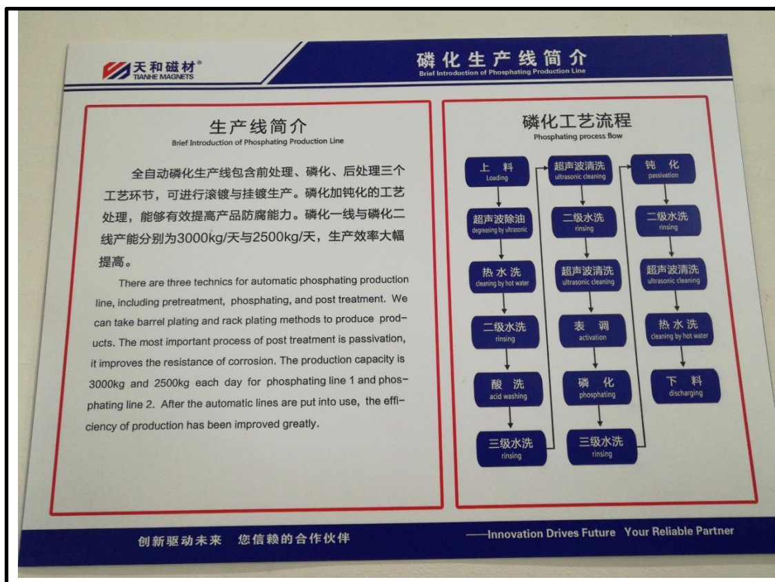
图 3-11 磷化生产工艺流程图
