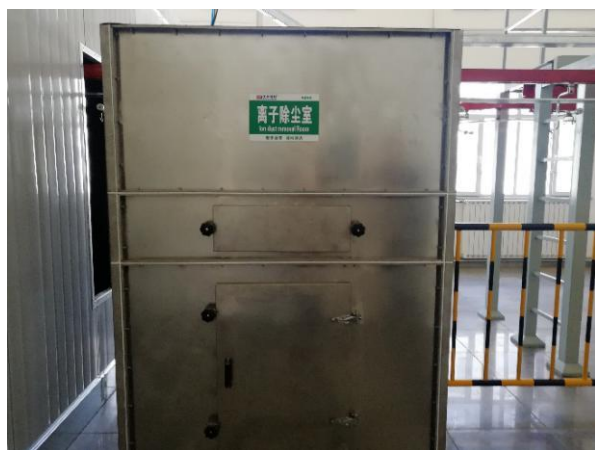
喷涂工序的离子除尘室
