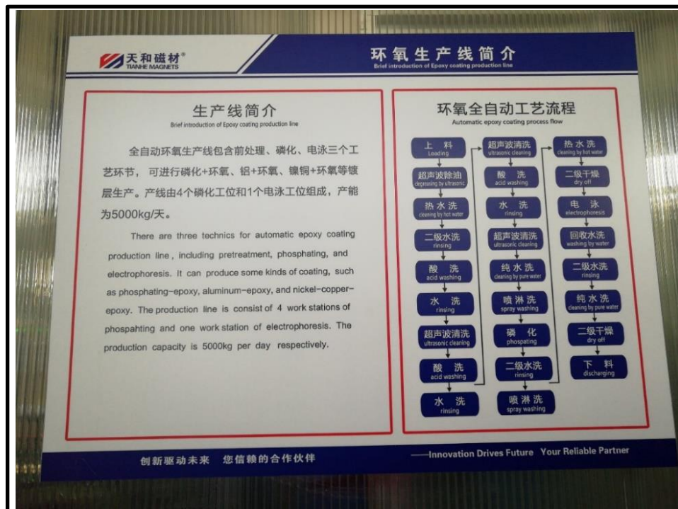
图 3-12 电泳生产工艺流程图
