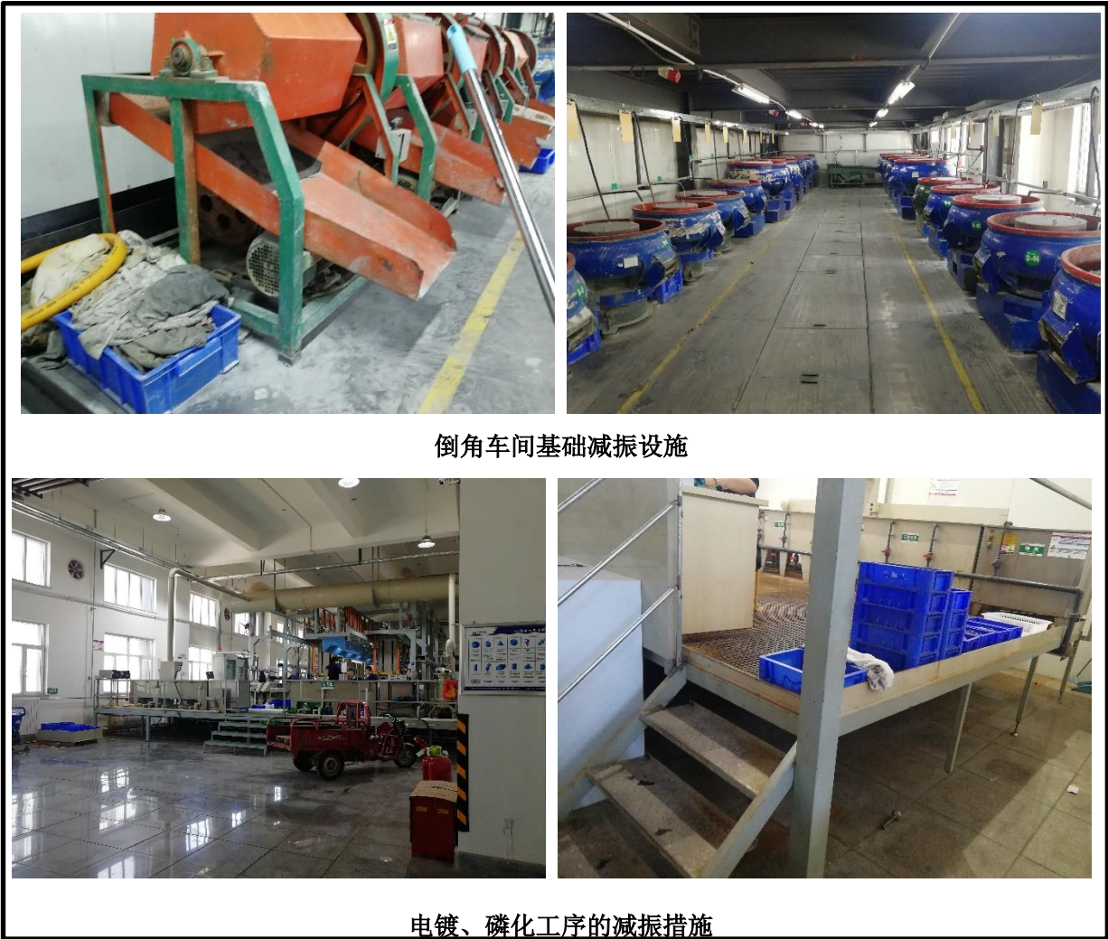
图 4-5 噪声治理措施（基础减振、厂房隔声）
